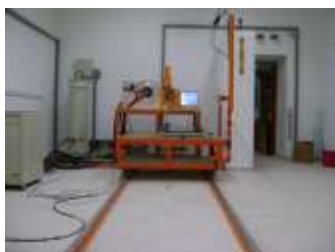
Salle d'irradiation du lab. d'étalonnage abritant un tube à RX et un irradiateur de rayons \gamma
